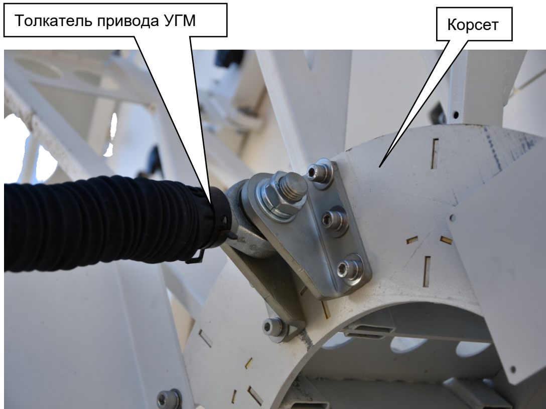
Рисунок 30 – Монтаж привода УГМ к корсету рефлектора
