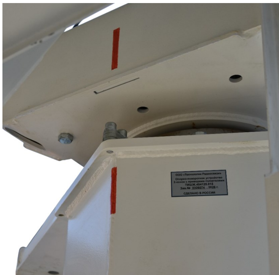
Рисунок 21 – Метка положения «0» по азимуту на ребре колонны и подвижной азимутальной частью ОПУ.
